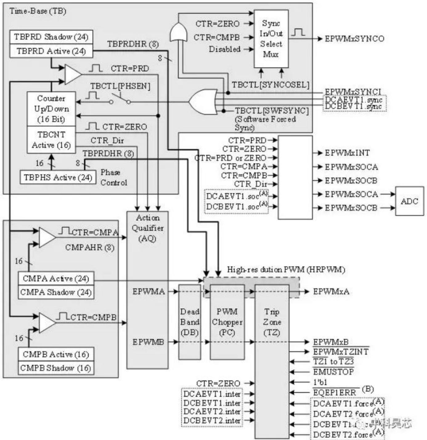
主要由时基计数器 TB，计数比较 CC、动作 AQ、事件 ET、死区 DB、斩波 PC、错误联防 TZ 与时间比较 DC 模块组成，其中 TB、CC、AQ、ET 是电机调速控制中最重要的四个模块，其使用配置原理为：
