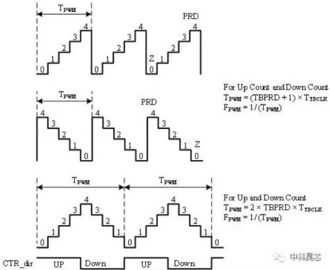
分频计算公式为： $TBCLK = SYSCLKOUT / (HSPCLKDIV * CLKDIV)$  配置 EPWMxSYNC 管理 ePWM 模块间的同步；配置 TBPHS 调节两路 PWM 输出的相位差；产生 CTR=PRD 与 CTR=ZERO 事件。
